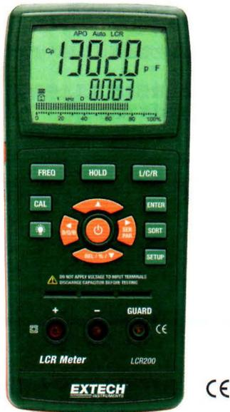
可完成 **L、C、R** 测量且测试频率高达 **100kHz**
