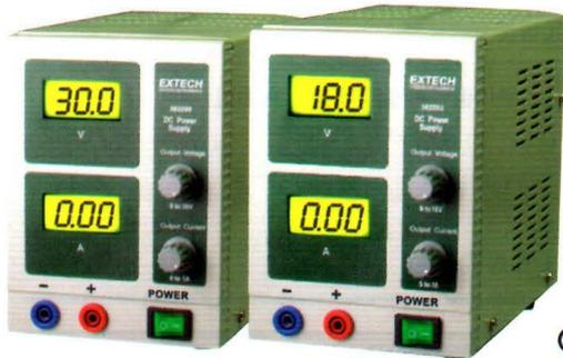
可调节30V/1A和18V/3A供应器，带LCD显示屏
