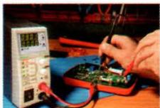
电流限制的直流供应器，供电子维修和校准
