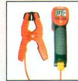
42515-T包含 免费 K型管夹 (TP200) 温度探针
